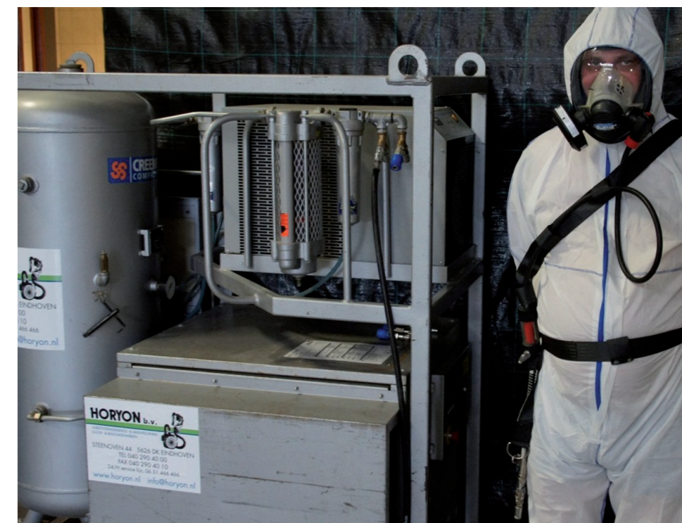
Motoraangedreven filtersysteem met volgelaatsmasker - onafhankelijke adembescherming
