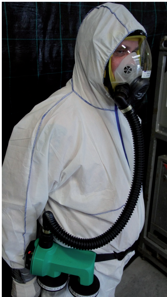
Motoraangedreven filtersysteem met volgelaatsmasker - afhankelijke adembescherming
